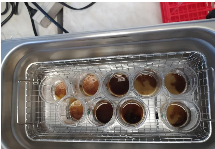
Figura 30. Obtención de extracto de hongo Brindis mediante el método de ultrasonido
