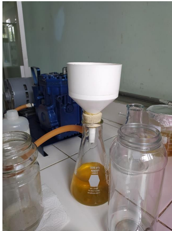
Figura 26. Filtración del precipitado con un embudo Buchner, en el procedimiento de medición de fibra dietaria.
