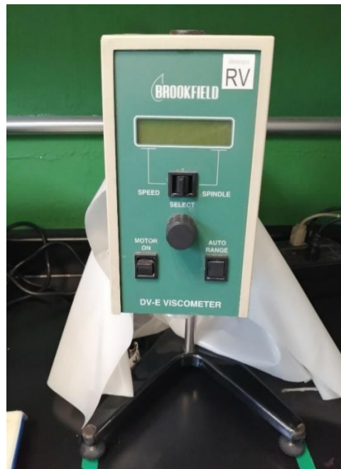
Figura 10. Viscosímetro para medir la viscosidad de PVA y PVA/betabel.
