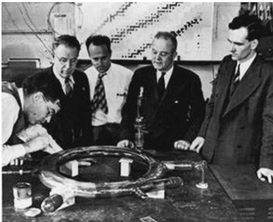
Fig. 1.2. Científicos en General Electric que inspeccionan la cámara de vacío del sincrotrón de 70 MeV en la que se observó por primera vez la radiación sincrotrón. De izquierda a derecha: Robert Langmuir, Frank Elder, Toly Gurewitsch, Ernest Charlton y Herb Pollock.
