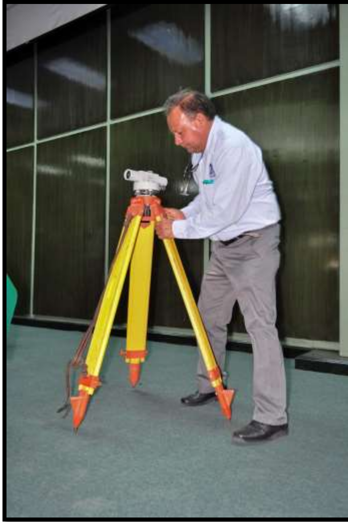
Foto 1. Ingeniero Joel Panohaya Analco montando el nivel geodésico. (Fuente: Foto del autor).
