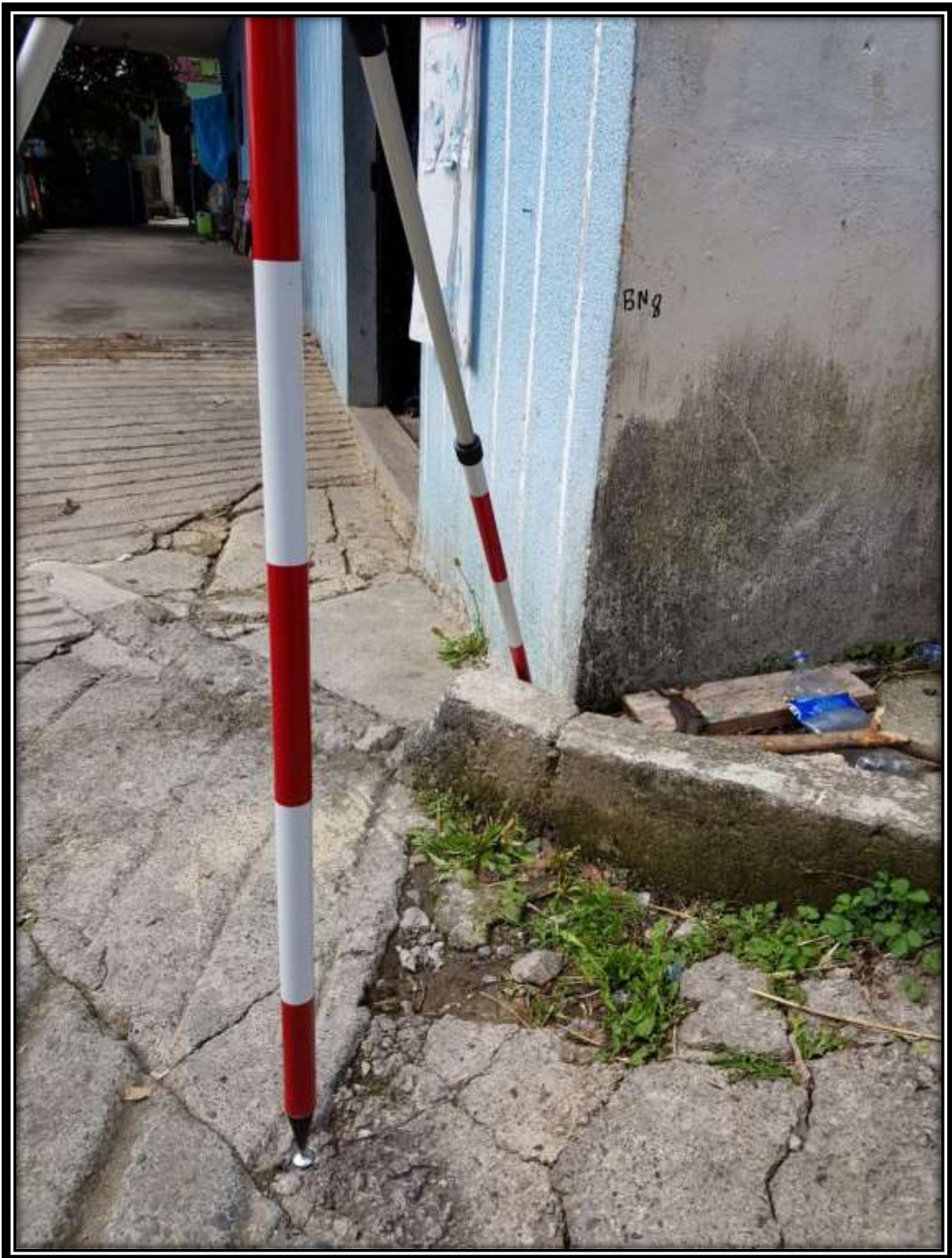
Imagen 24. B.N. y marcaje en pared de casa para no perder el marcaje. (Fuente: foto del autor)
