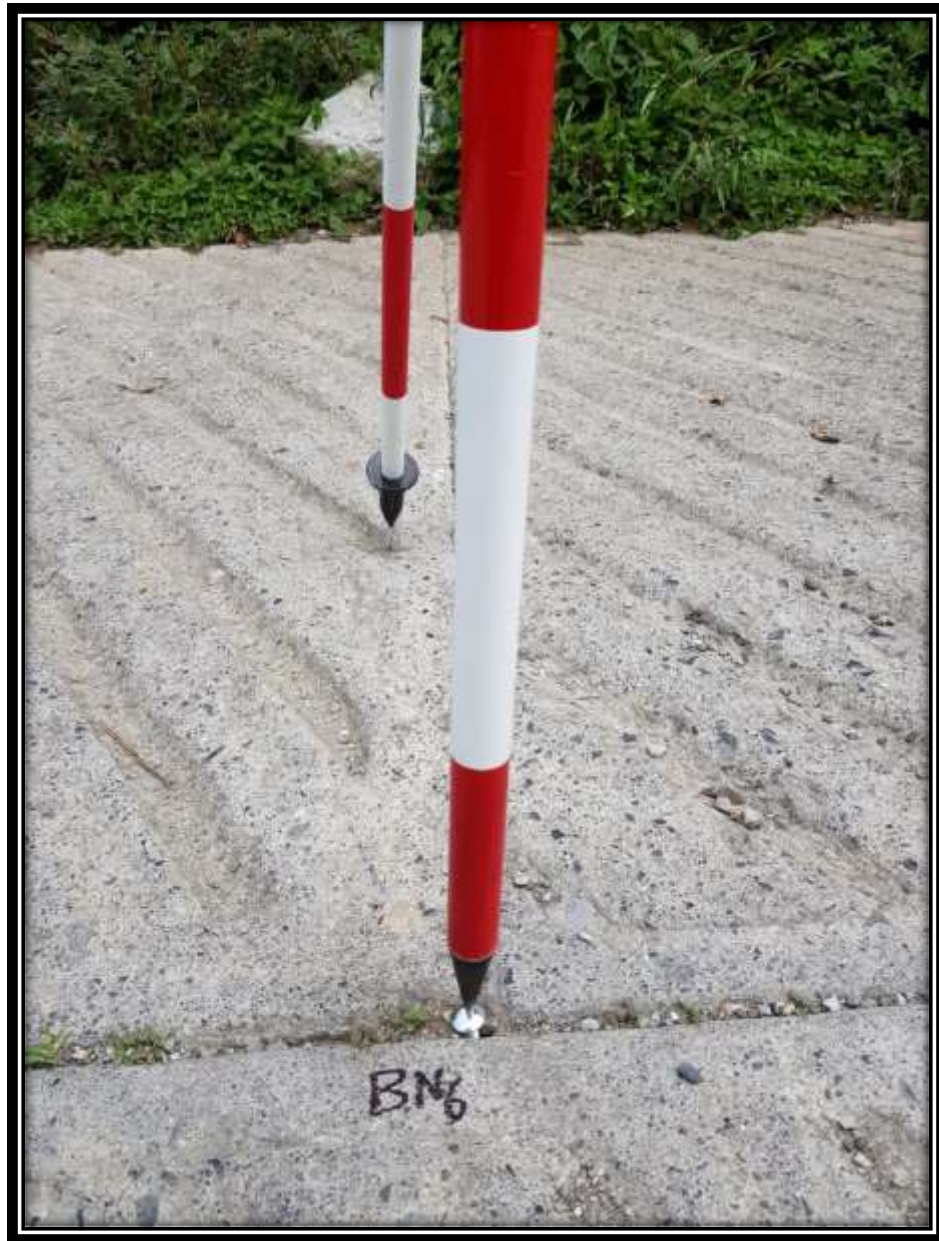
Imagen 20. Colocación de tornillo de cabeza redonda y marcaje del mismo. (Fuente: foto del autor)
