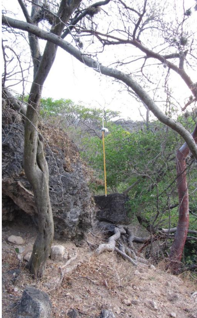
Figura 4. Termómetro (marca Taylor rango de 0-100 °C) colocado en la zona de estudio para la toma de temperatura de las 8:00-18:00 horas.
