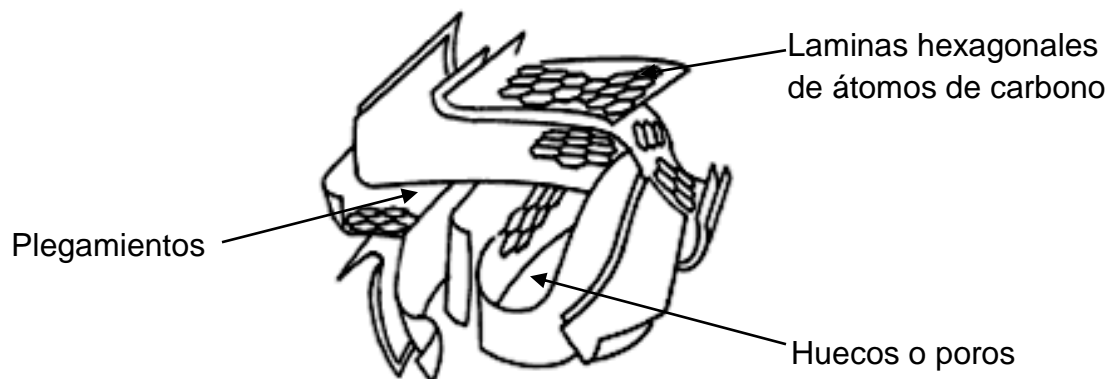
Fig.1.1 Estructura del carbón activado
