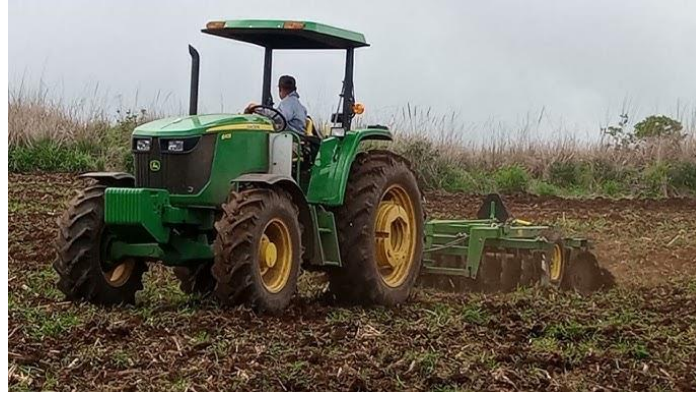
Ilustración 2. Tractor John Deere modelo 6403 doble tracción con estación del operador abierta preparando el suelo con una rastra John Deere modelo MX225 de 24 discos
