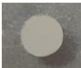
Figura 3.1. Polvo comprimido (pastilla) de ZnO.
