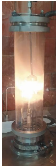
Figura 3.3. Proceso de depósito de la película de ZnO por el método HFCVD.
