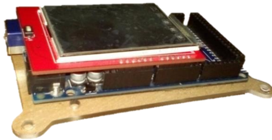
Figura 13. Conexión de la pantalla TFT a Arduino
