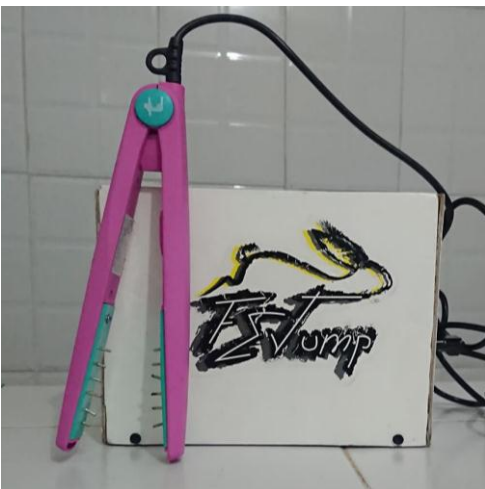
Figura 9: Insensibilizador eléctrico y logo para conejos.
