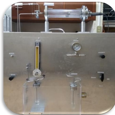
Figura 2.4 a) Diagrama de conexiones de un sistema HFCVD [45]. b) Foto del sistema HFCVD.
