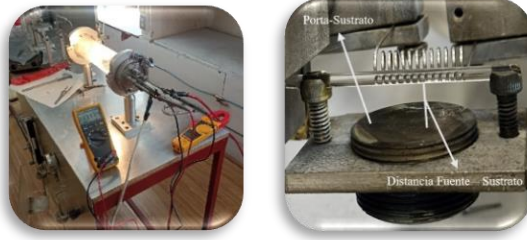
Figura 3.6 Acondicionamiento del sistema HFCVD para el tratamiento térmico de películas en ambiente de H_2 .
