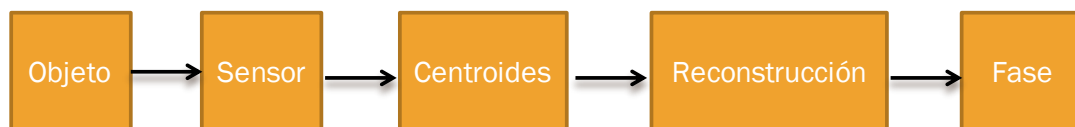
Figura 2. 5. Diagrama de flujo de la figura se sintetiza el proceso de reconstrucción de fase para el caso de un sensor de tipo S-H.
