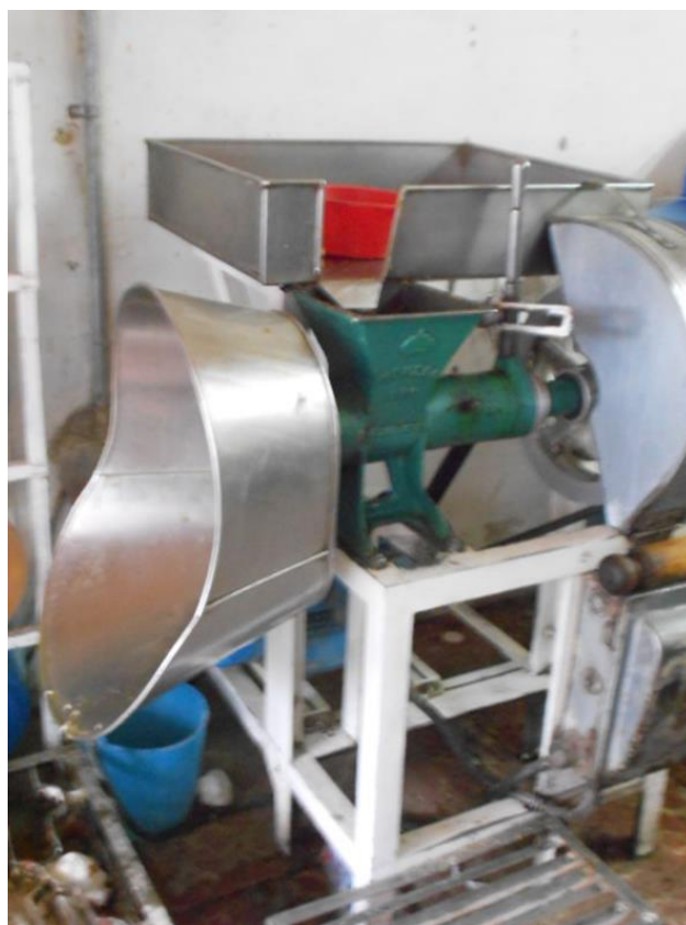
Máquina de turbinas para llevar a cabo la molienda de ingredientes como el maíz.
