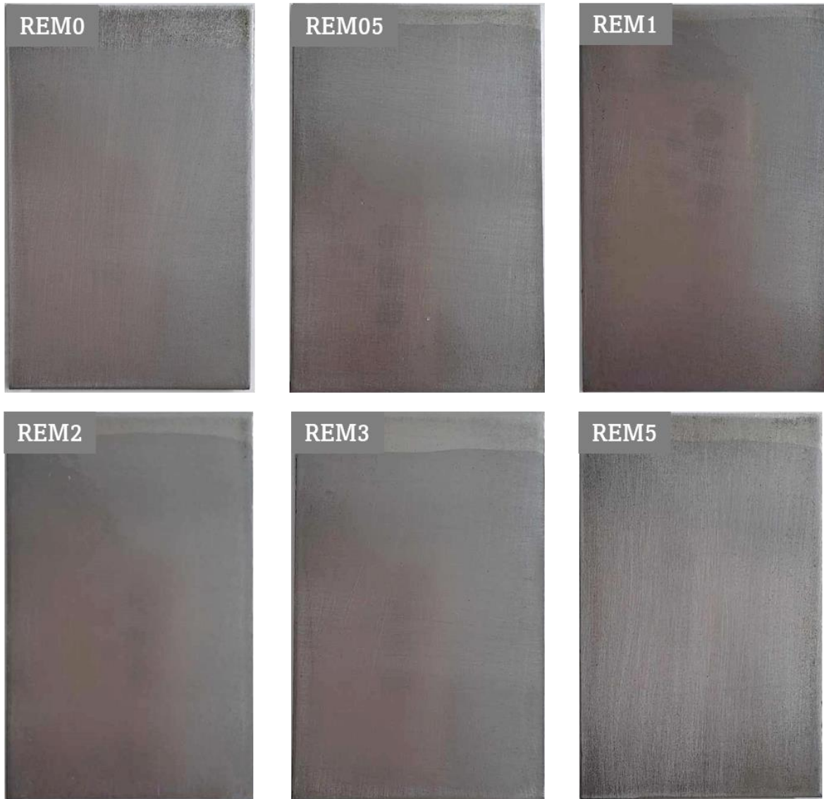
Figura 18. Recubrimientos (resina epóxica base agua-montmorillonita) sobre sustratos de acero al carbón.
