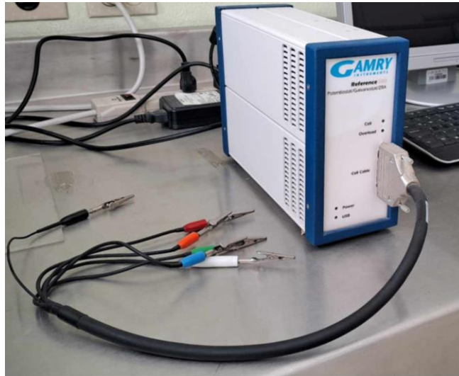
Figura 16. Equipo de análisis para espectroscopia de impedancia electroquímica marca GAMRY.
