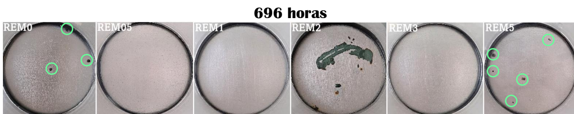
Figura 29. Evaluación visual del grado de oxidación en superficies de acero recubiertas utilizando la norma ASTM D 610-01
