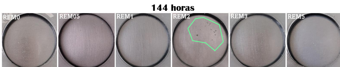
Figura 27. Evaluación visual del grado de oxidación en superficies de acero recubiertas utilizando la norma ASTM D 610-01
