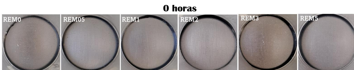
Figura 26. Evaluación visual del grado de oxidación en superficies de acero recubiertas utilizando la norma ASTM D 610-01
