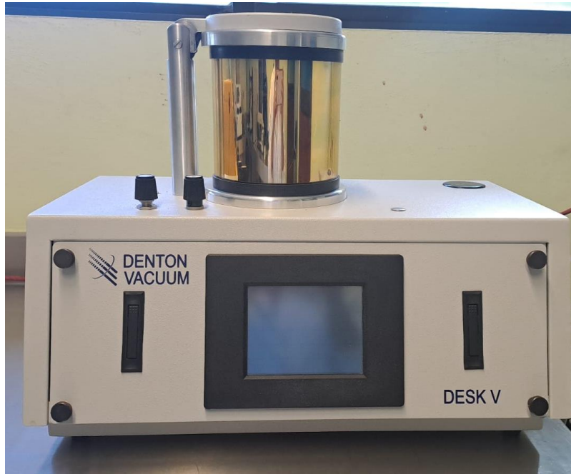
Figura 14. Equipo DENTON VACUUM, DESK V (Sputter).
