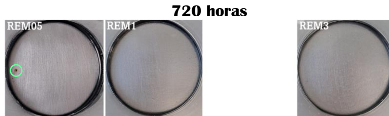
Figura 30. Evaluación visual del grado de oxidación en superficies de acero recubiertas utilizando la norma ASTM D 610-01
