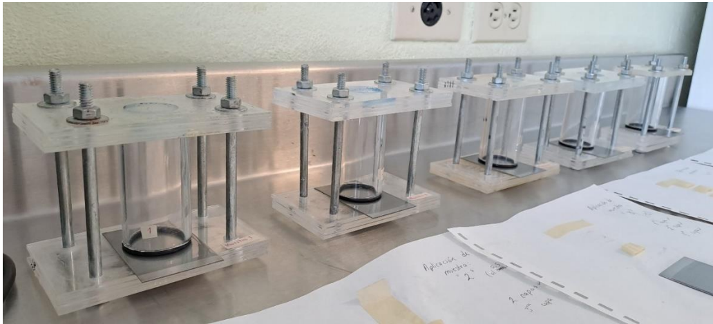
Figura15. Creación de celdas para para recubrimiento.
