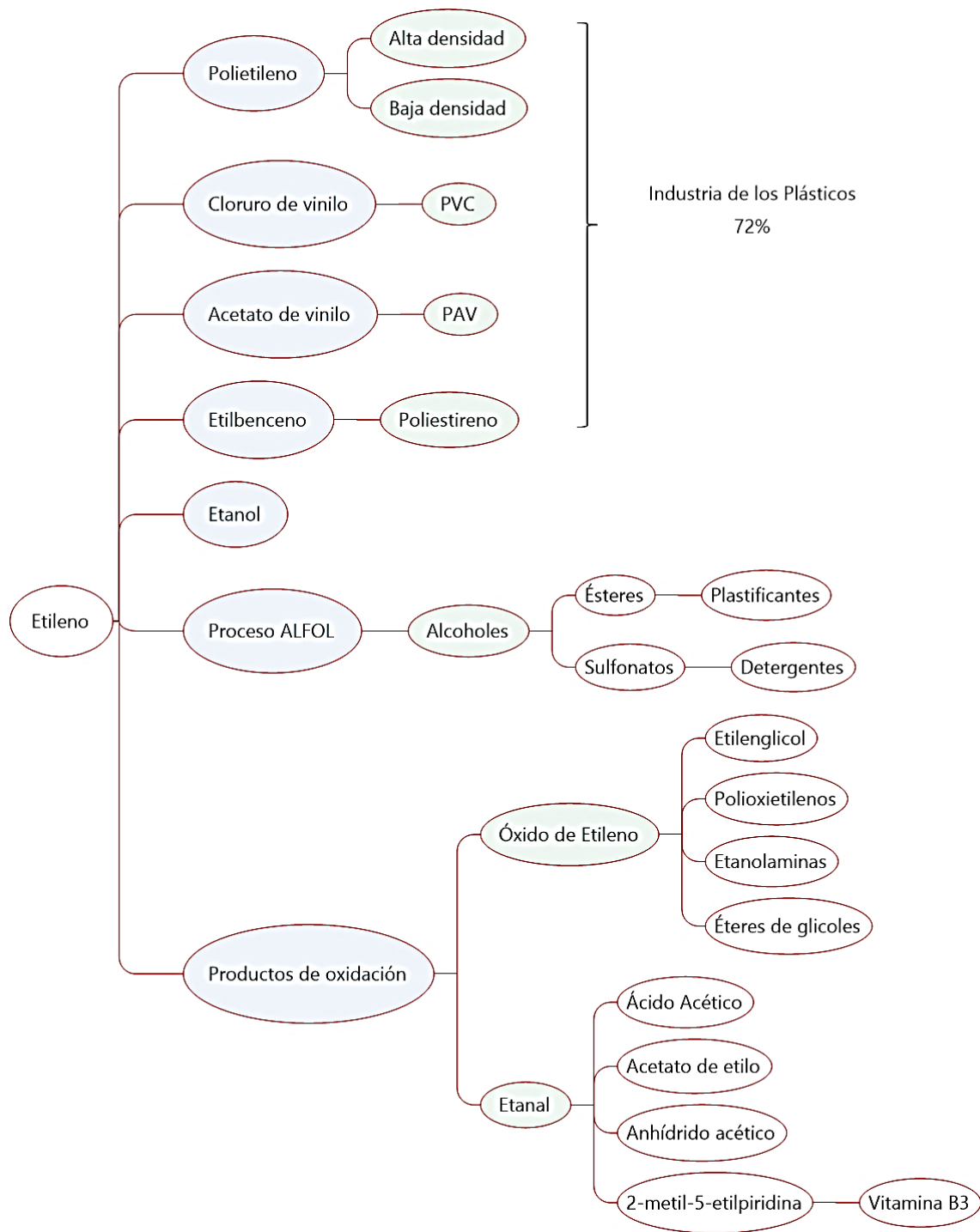
Figura 1.1. -Diagrama que muestra los principales productos intermedios y finales derivados de las reacciones químicas aplicadas al etileno (Markit, 2019)
