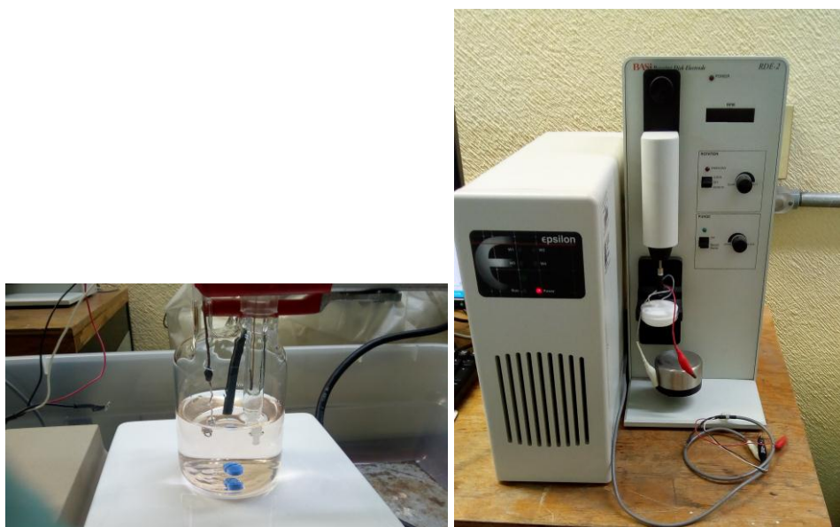
Fig. 2.4. Celda Electroquímica de tres electrodos y Potenciostato – Galvanostato Epsilon (Bioanalytical Systems), BASi-Epsilon EC (v. 2. 13. 77).
