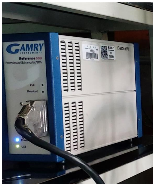
Figura 9. Potenciostato utilizado en el sistema de electrodeposición.
