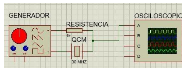
Figura 3.2: Circuito del sistema de obtención de datos QCM.
