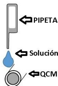
Figura 2.12: Método de depósito de películas por casting [12].
