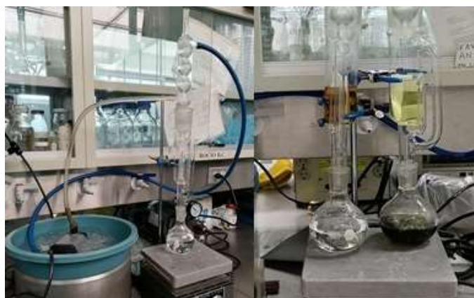
Ilustración 6. Del lado izquierdo se muestra el equipo para realizar la fitoextracción por el método Soxhlet y en la parte derecha la etapa final de la extracción de los principios activos de las plantas medicinales. Fuente: Elaboración propia.
