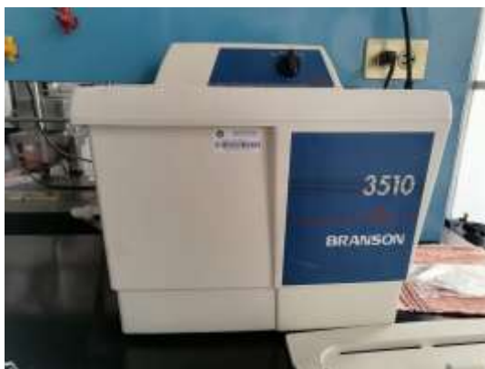
Ilustración 5. Equipo de ultrasonificación marca Branson modelo 3510-DTH empleado para mejora la extracción de los principios activos en las plantas de estudio. Fuente: Elaboración propia.
