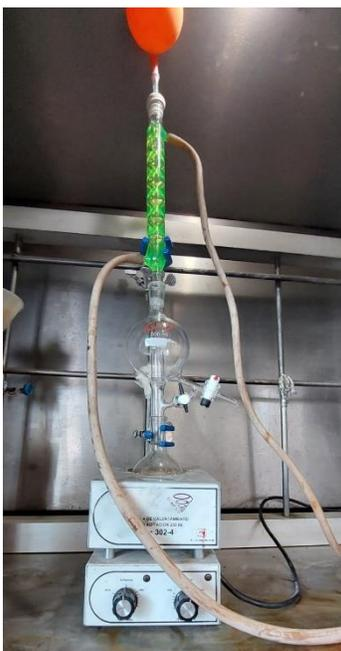
*Figura 2.3 Sistema para la purificación de THF*
