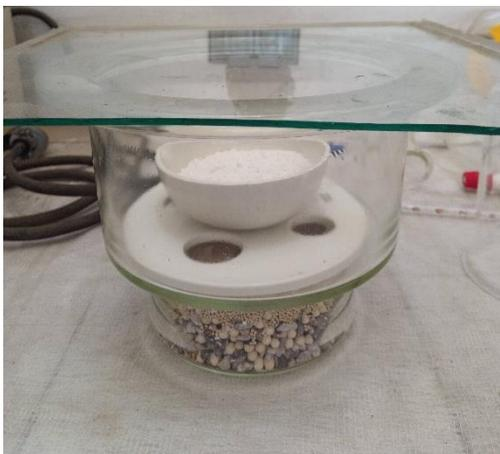
*Figura 2.2 Muestra de CaO enfriándose en un desecador*
