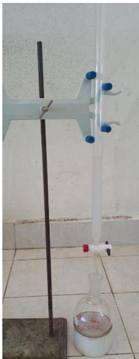
*Figura 2.7 Columna cromatográfica*
