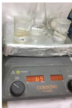
Figura 21. Muestra textil sumergida en HDTMS.
