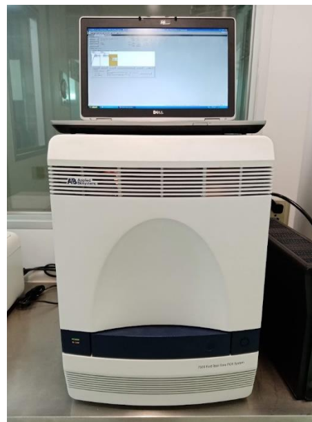
Figura 21. Equipo Applied Biosystems 7500 Fast Real-Time PCR System , con la PC destinada al equipo.
