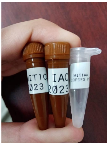
Figura 20. Tubos de microcentrífuga conteniendo las sondas para el gen Mit1C, el control IAC y el control positivo sintético de C. cayetanensis
