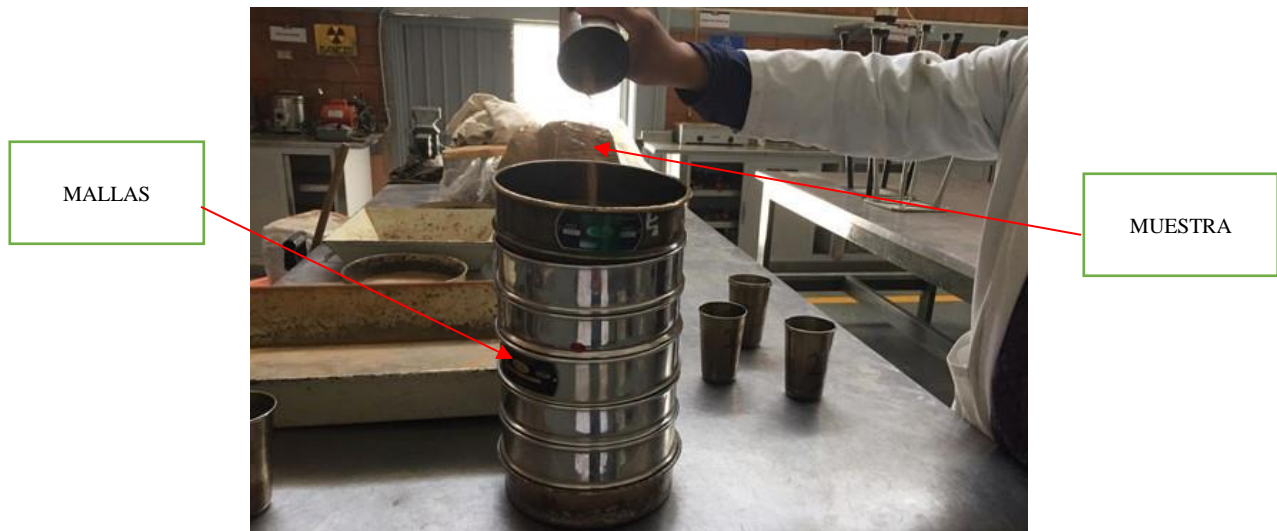
Figura 3.7 Granulometría por mallas (Laboratorio integral FI-BUAP)
