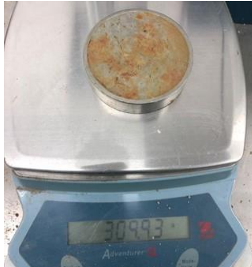
Figura 3.17 Peso de la probeta con anillo (Laboratorio integral FI-BUAP)
