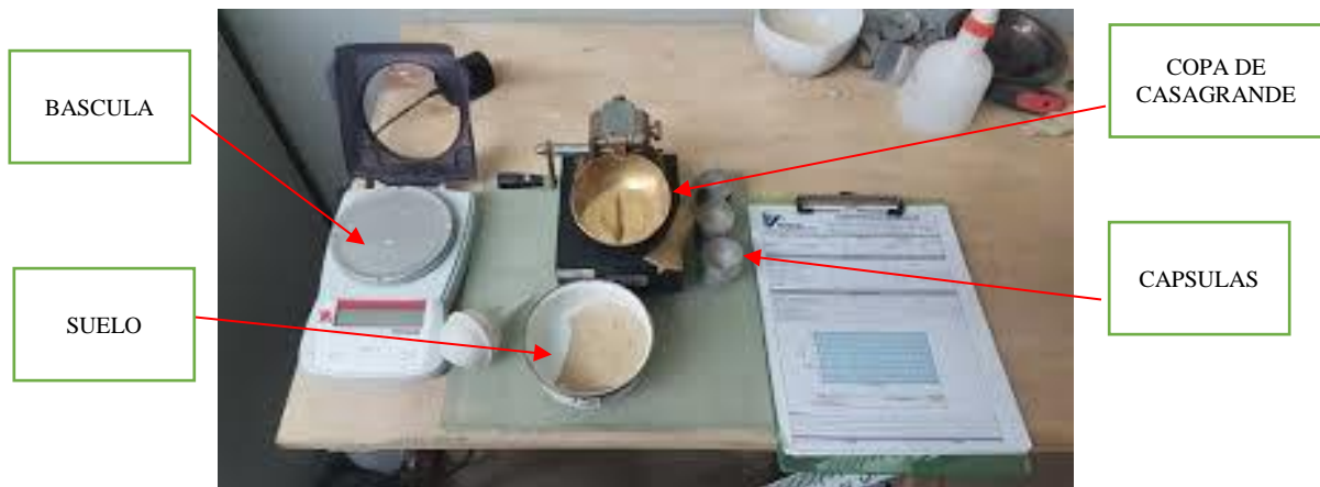
Figura 3.5 Determinación del límite líquido (Laboratorio integral FI-BUAP)
