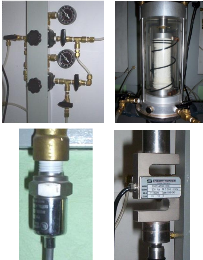
Figura 3.13 Sistema de la Cámara Triaxial (Laboratorio integral FI-BUAP)
