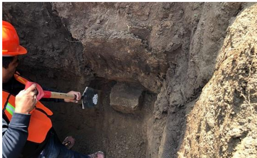
Figura 3.2 labrado de muestra inalterada
