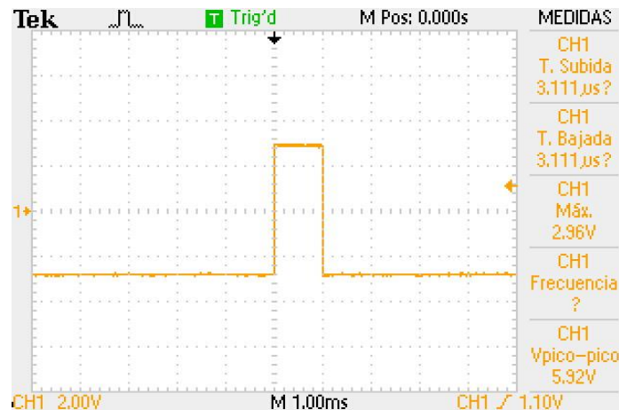
Figura 73: Función pulso de 100 Hz con 10% del ciclo de trabajo.
