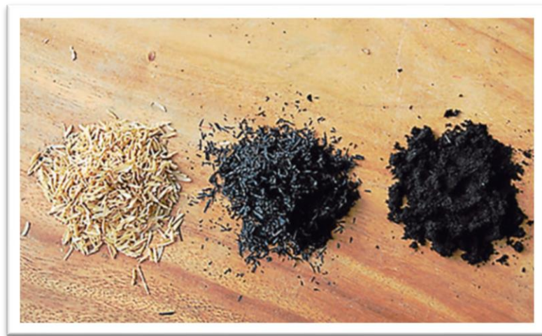
Figura 1.2: Cáscara de arroz antes y después de su uso en la purificación.
