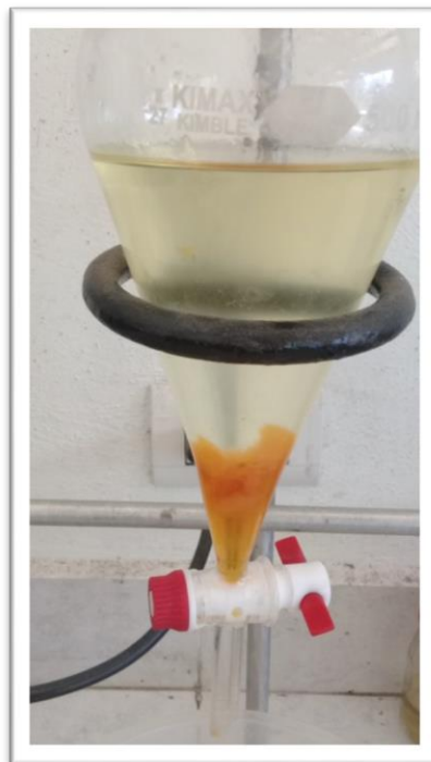
Figura 3.1 Biodiesel en decantado para pruebas de saponificación.
