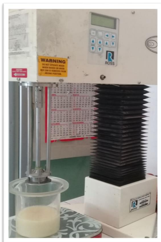
Figura 2.6: Dispensor utilizado para reacción de transesterificación.
