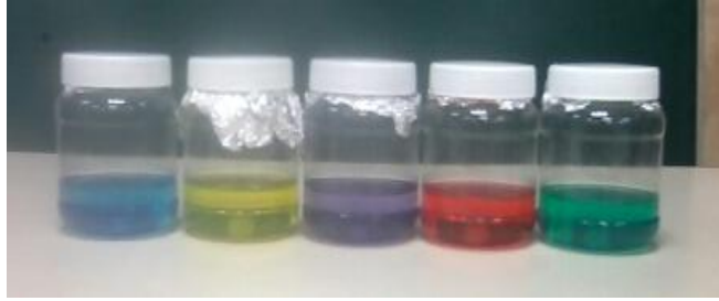
Figura 4.4. Muestras de alcohol con colorante y diferente coeficiente de absorción \alpha .
