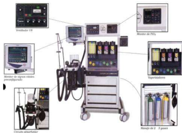
Figura 2 Componentes de la máquina de anestesia tomada de: secretaria de salud. Guía tecnológica no.10 sistema de anestesia. cenetc salud. Dic 2004 México; p 2
