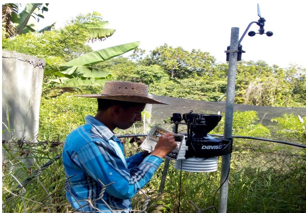
Figura 5. Instalación de la estación meteorológica
