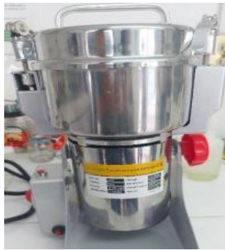
Figura 4. Molino utilizado para la pulverización del esqueleto de camarón.
