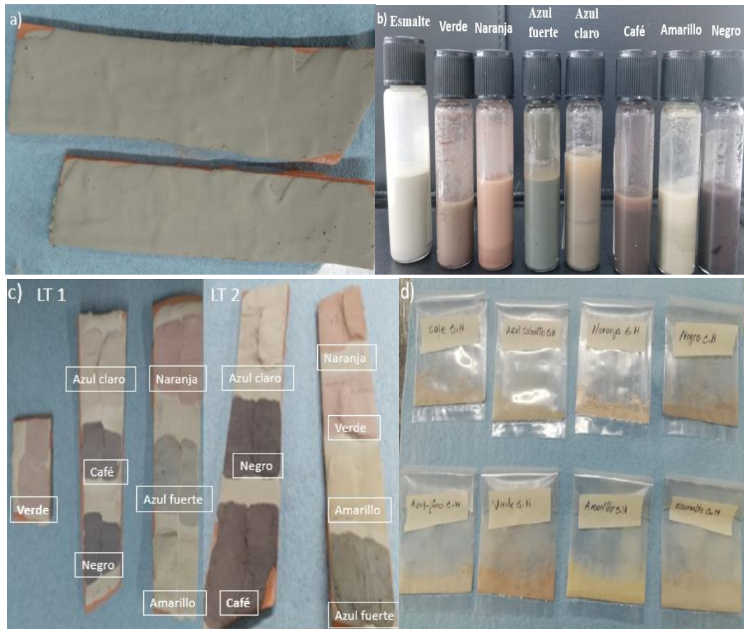
Figura 4.3 (a) Jahuete esmaltado, (b) muestra de los colorantes, (c) colorantes aplicados al jahuete esmaltado (LT 1 y LT 2) y (d) esmalte y colorantes (polvo fino).
