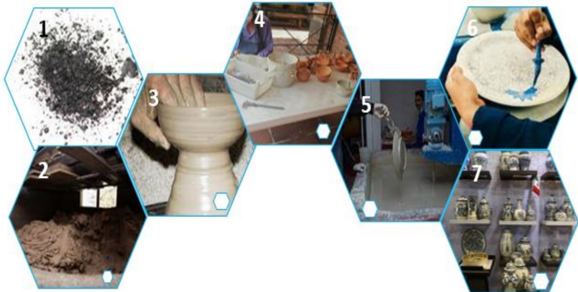
Figura 4.1 Proceso de elaboración de la cerámica Talavera Poblana: 1) arcilla negra, 2) pasta de barro, 3) moldeado, 4) jahuete, 5) esmalte por inmersión, 6) decoración y 7) cerámica vitrificada.
