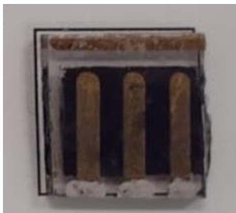
Figura 3.6: Imagen fotográfica de una celda solar basada en perovskita FAMA, después del depósito con los contactos de oro.
