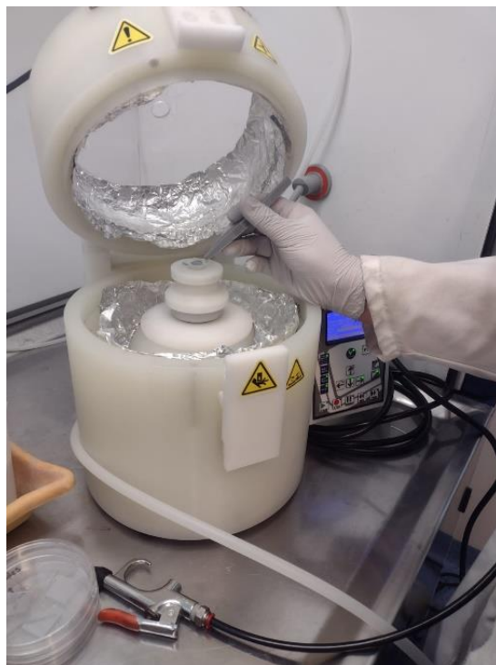
Figura 3.3: Equipo de depósito por rotación (Modelo WS-650SZ-23NPP/A2 marca Laurell) utilizado para depositar la capa mesoporosa de \text{TiO}_2 .
