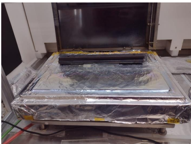
Figura 3.2: a) Parrilla eléctrica de altas temperaturas y b) sistema de aplicación de la capa compacta de TiO 2 .
