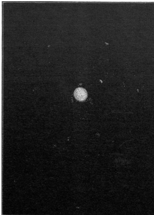
Figura 28.- Fotografía de un corte paralelo al plano (111), con el método de Laue del Diamante.
