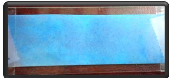
Figura 36.- Polvo de azurita en tamiz de 200, montada en cinta especial y en vidrio.
