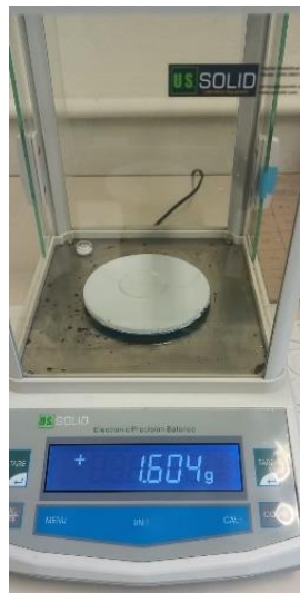
Figura 11. Balanza analítica para la medición del disco de acrílico (Fuente propia).
