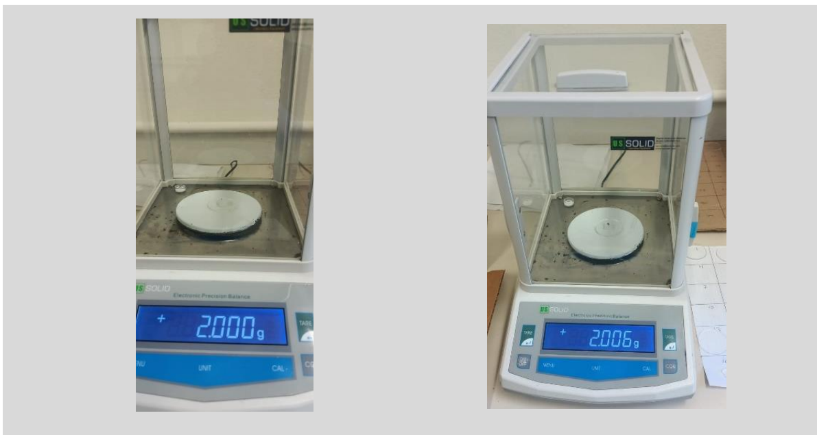
Figura 13. Balanza analítica para la medición del disco de acrílico ya conformado (Fuente propia).
