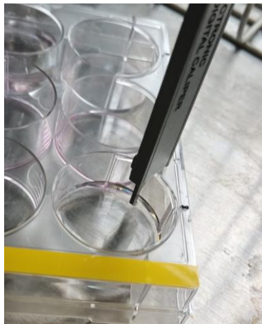
Figura 7. Toma de medidas de pocillo para diseño de disco de compresión (Fuente propia).
