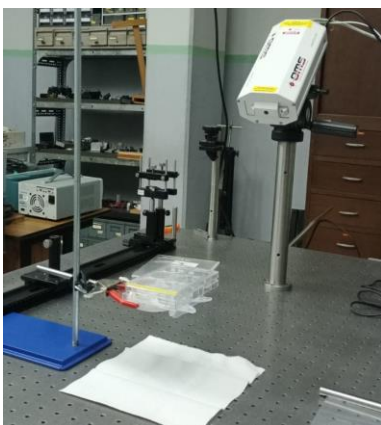
Figura 15. Prueba piloto. Ubicación de experimento y vibrómetro en posición para mediciones (Fuente propia).
