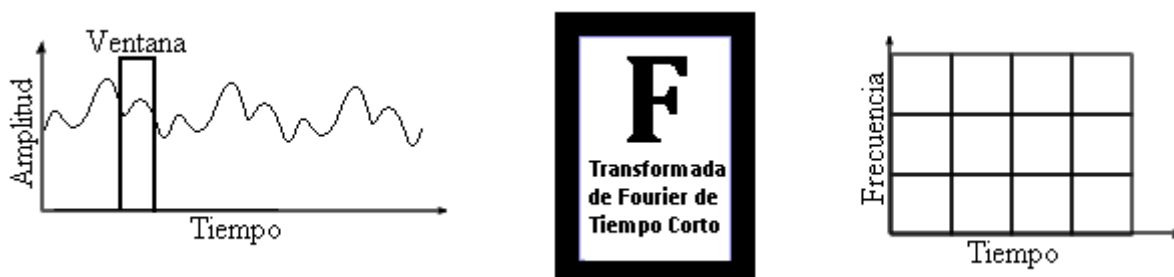
Figura 3.2: La transformada de Fourier de tiempo corto mapea a una señal unidimensional en el dominio del tiempo (izquierda) en una función dos-dimensional de tiempo y frecuencia (derecha) [17].
