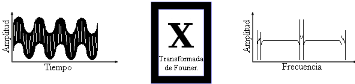
Figura 3.1: La transformada de Fourier convierte una señal unidimensional en el dominio del tiempo (izquierda) al dominio de frecuencia (derecha) [17].
