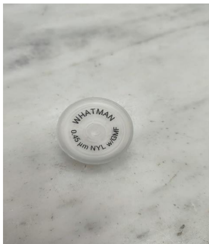
Figura 27 Filtro empleado para separar la fase sólida de la muestra. Fuente: Autor
