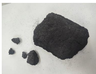
Figura 18 Carbón mineral empleado como soporte para la fabricación de fotocatalizadores. Fuente: Autor
