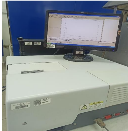
Figura 22 Espectrofotómetro UV-Vis empleado en las pruebas de absorbancia. Fuente: Autor
