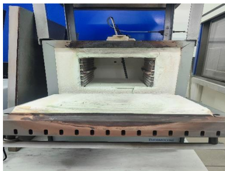
Figura 21 Mufla Thermolyne empleada en la fabricación de fotocatalizadores. Fuente: Autor
