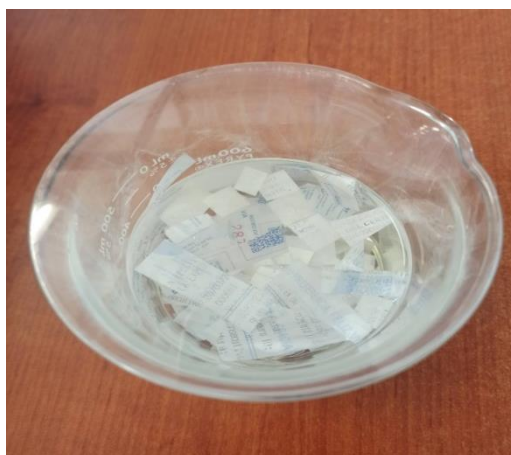
Figura 15 Inmersión de tickets térmicos en agua destilada. Fuente: Autor
