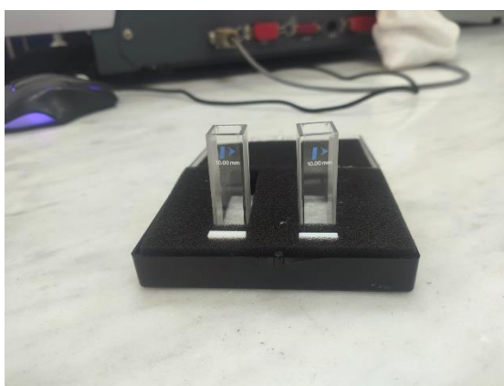
Figura 28 Cubetas de cuarzo para análisis espectroscópico UV-Vis, muestras líquidas. Fuente: Autor.
