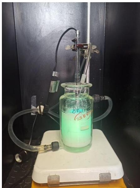
Figura 25 Sistema fotocatalítico en funcionamiento. Fuente: Autor
