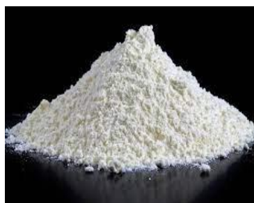
Figura 20 Dióxido de Titanio empleado como soporte para la fabricación de fotocatalizadores. Fuente: Sitio web
