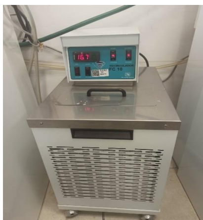
Figura 24 Sistema de refrigeración del reactor fotocatalítico. Fuente: Autor
