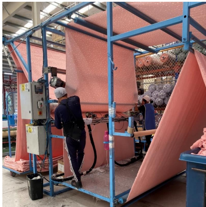
Imagen 3.4 Máquina pegadora (Pegado de tela con guata).
