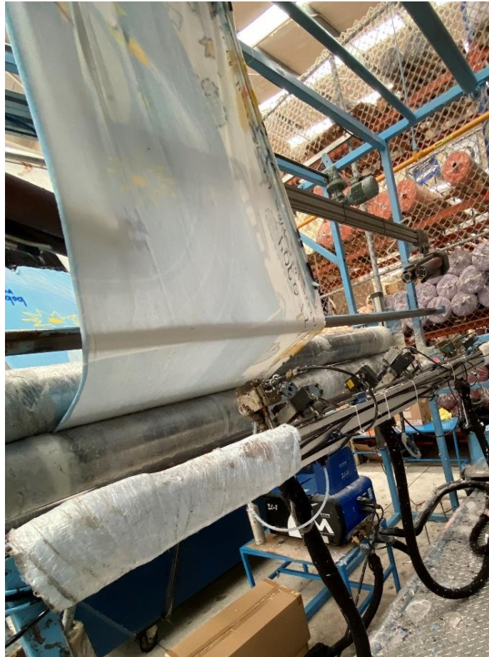
Imagen 3.7 Máquina pegadora (Pegado de bison con guata).
