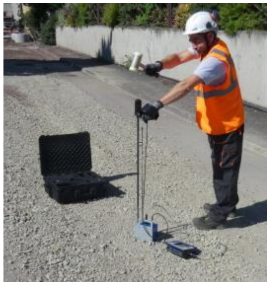
Fotografía 3. Operación del penetrómetro portátil Panda II
