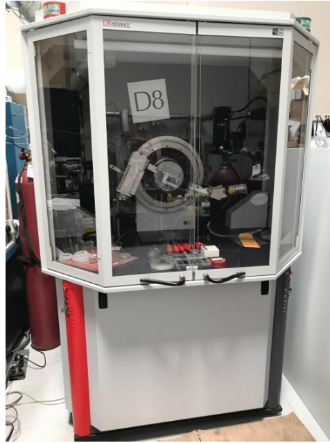
Figura 23. Equipo de Difracción de Rayos X.
