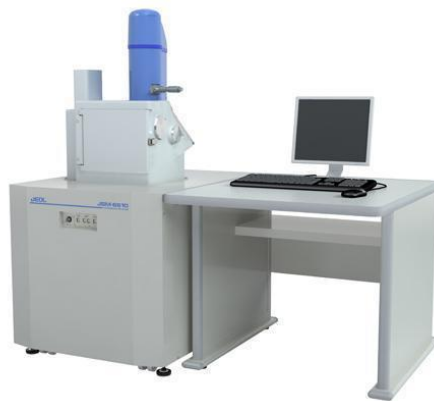
Figura 24. Microscopio electrónico de barrido.
