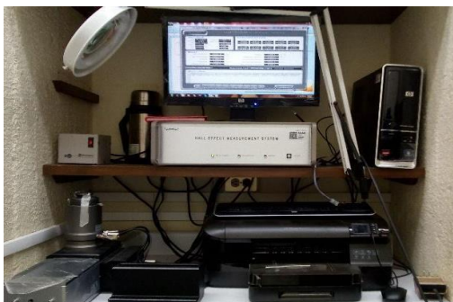
Figura 27. Sistema de efecto Hall.
