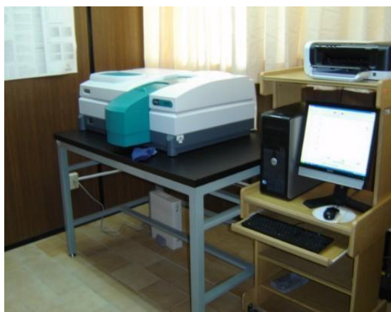
Figura 28. Espectrofotómetro UV - Vis - NIR.
