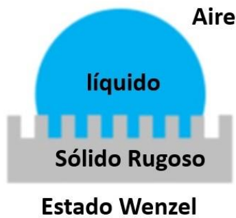
Figura 1.3. Superficie solida estructurada con un mojado completo adicional se suma la integración de un factor de rugosidad (modelo de Wenzel) [51].
