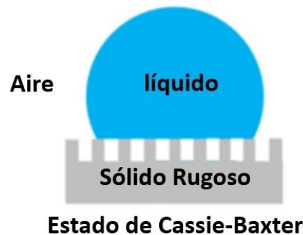
Figura 1.4. Estructura de una superficie sólida que permite un mojado parcial (modelo de Cassie-Baxter) [51].
