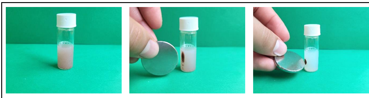
Figura 2.5 Recuperación de TF suspendido en agua utilizando un imán comercial.
