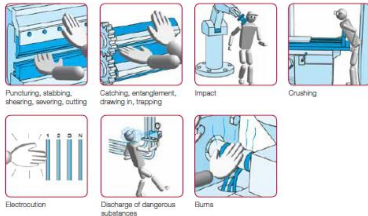
Figura 3.2. Ejemplos típicos de peligros que se pueden encontrar en la industrial. Safe Machinery Handbook, Schneider Electric. pp18.
