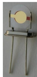
Figura 2.9: QCM sin la cubierta metálica.
