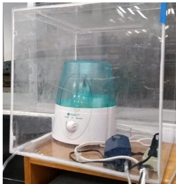
Figura 3.5: Camara generadora humedad controlada.
