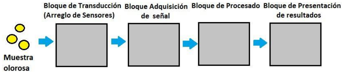
Figura 2.1: Esquema general de una nariz electrónica.
