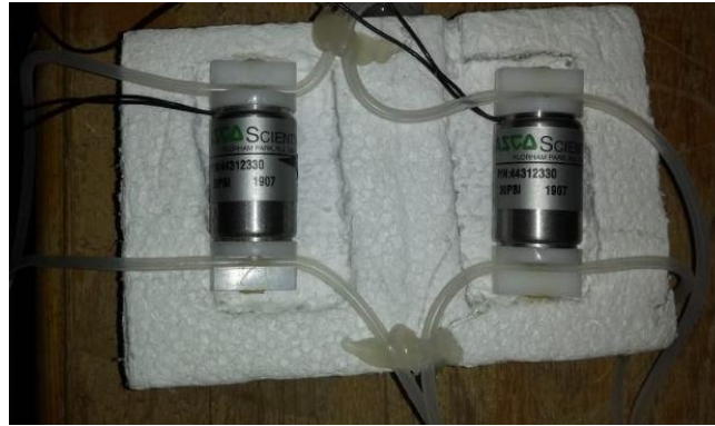
Figura 3.13: Válvulas Asco 2 vías.
