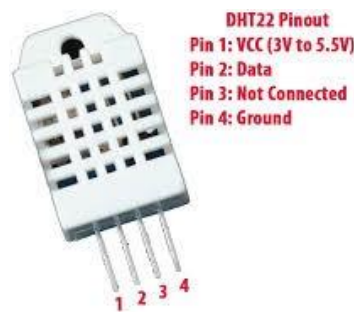
Figura 3.7: Sensor Digital Humedad Relativa y Temperatura DHT22.
