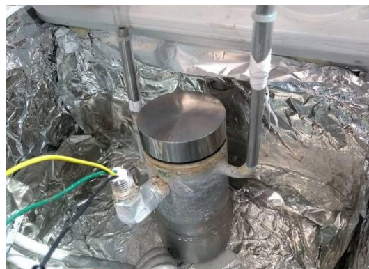
Figura 3.12: Cámara generadora COV en su baño térmico
