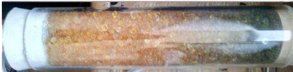
Figura 3.10: Filtro de humedad a base de silica gel.
