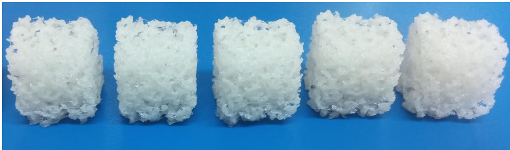
Figura 3.18- . Fotografía de los andamios obtenidos en ácido poliláctico con dimensiones 25×25×25 mm.
