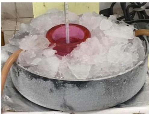
**Figura 2. 1** Preenfriamiento de la solución a alcalina
