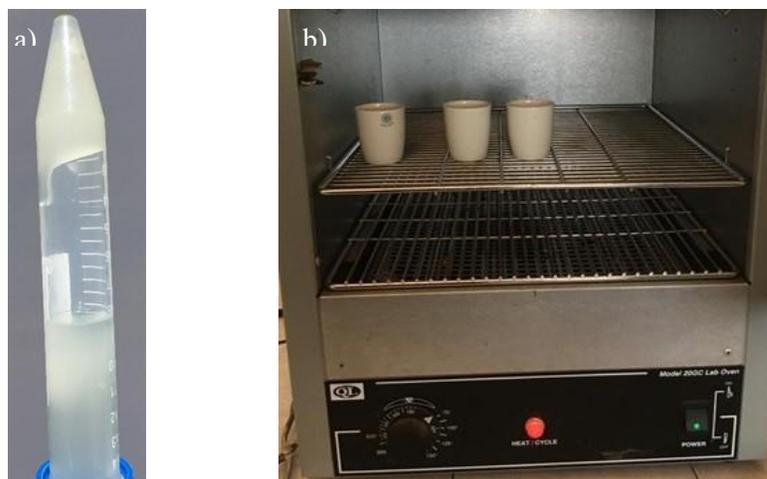
**Figura 2. 3** a) Solución sobrenadante y parte insoluble de la celulosa. b) Secado de la fracción insoluble de la celulosa
