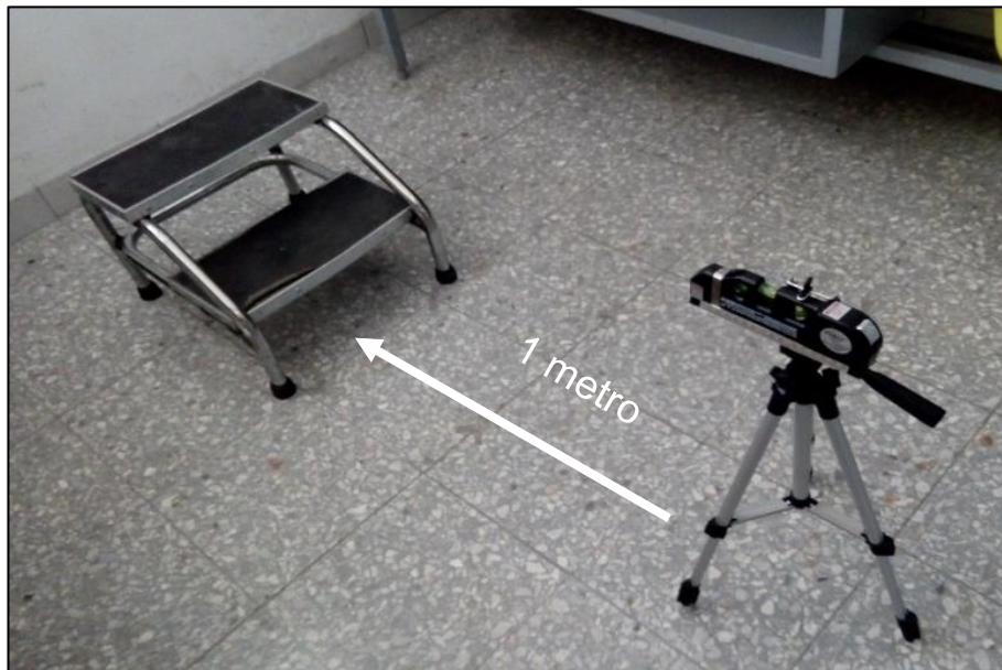
Figura 2. Colocación del nivel laser y área de exploración Fuente: Tepox, 2020
