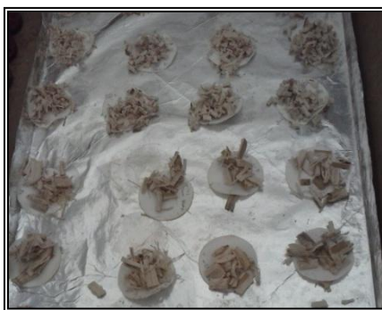
Figura 3.17: Muestras de bagazo de caña en la etapa de secado después de ser lavadas..
