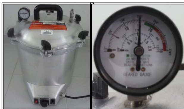
Figura 3.14: Autoclave utilizada en el desarrollo de muestras a presión a 15 psi.
