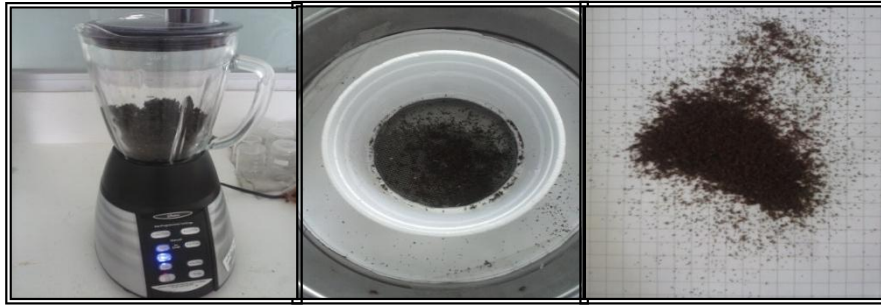
Figura 3.8: Cáscara de plátano en el proceso de molienda y tamizado
