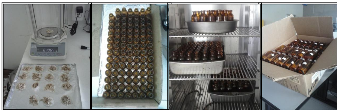
Figura 3.18: De izquierda a derecha: etapa de pesado, almacenamiento, remoción de humedad para caracterización y almacenamiento de muestras.
