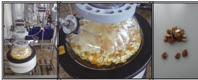
Figura 3.4: Proceso de remoción de aceites esenciales por arrastre de vapor para cáscara de naranja.
