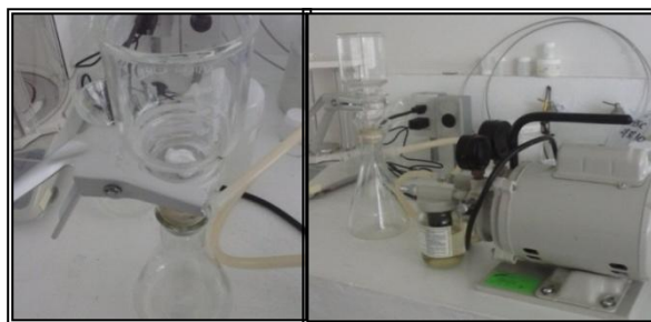
Figura 3.15: Proceso de filtración para muestras de algodón.
