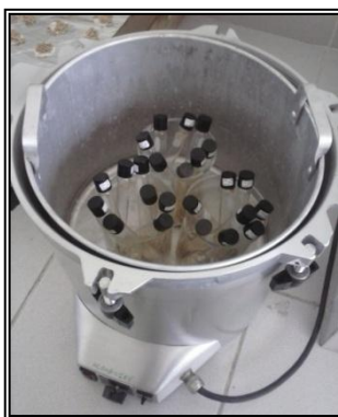
Figura 3.16: Muestras de bagazo de caña listas para hidrólisis termoquímica en autoclave.
