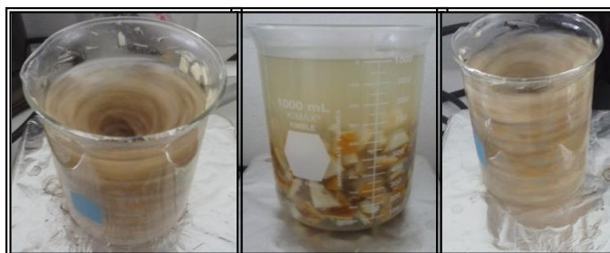
Figura 3.5: Lavados con agua destilada de los residuos propuestos a excepción del algodón.
