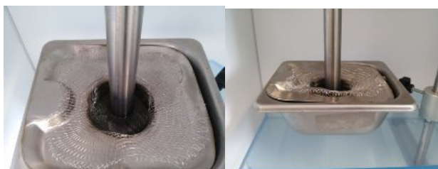
Figura 12. Dispositivo horizontal para tratamiento ultrasónico de hojas de brócoli.
