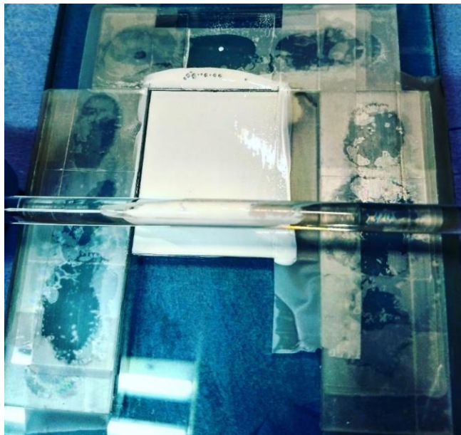
Figura 3.2 Depósito de TiO 2 por medio de la técnica de Dr. Blande.
