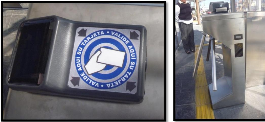
Figura 2. 15. Lectores de tarjetas electrónicas y torniquetes de validación
