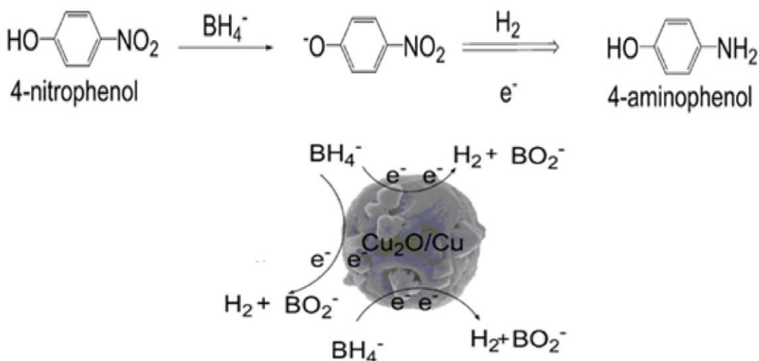
Figura 3.13. Mecanismo de reacción para la reducción catalítica de 4-NP a 4-AP [17].
