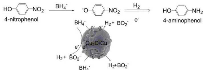
Figura 1. Esquema del mecanismo de reducción del 4-Nitrofenol. [17]
